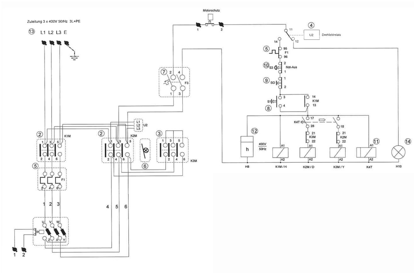
Fig. 3-3 Schema elettrico
